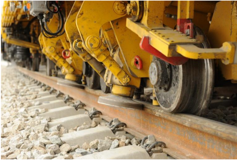
Imagen 9: Máquina compactadora de balasto
