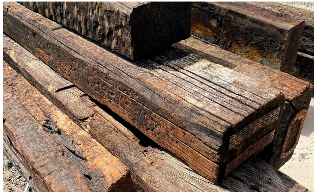
Imagen 12: Ejemplo de Creosota en durmientes de madera
